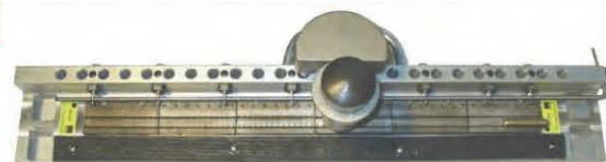
标准安装单元包含一个垫板和一个锤击头
