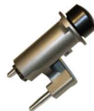
电锤锤击头用于安装MR30系列皮带扣，可以与所有SDS-MAX接头的电锤配合使用。
